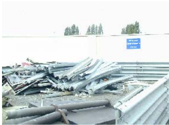
Figure 3 : stockage d'éléments métalliques glissières, supports détériorés (photo : DDE 36- Déchetterie du Parc de l'Équipement) . .
