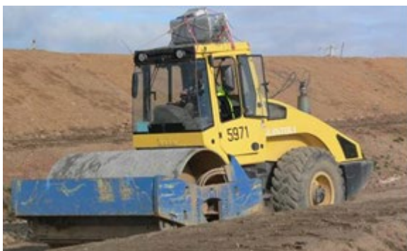
Figure 11 : Compacteur V5 instrumenté pour le suivi des émissions.
