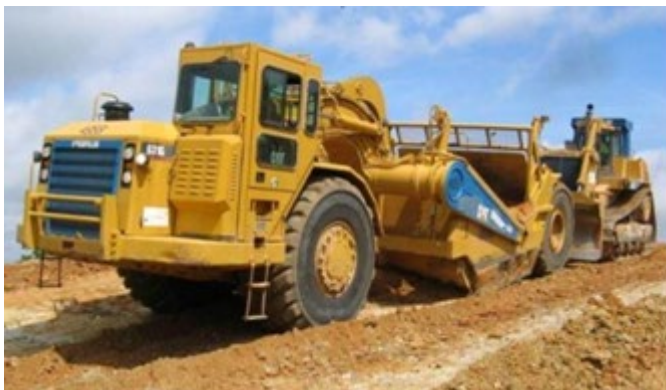
Figure 9 : Scaper 631 en cours de décapage.
