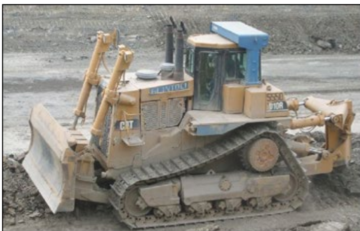
Figure 8 : Bulldozer D10T en cours de ripage.
