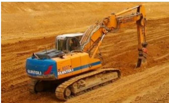
Figure 2 : La pelle 924 lors d'un creusement de tranchée.
