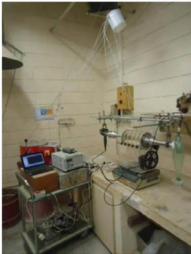
Fig. 3 : Démonstrateur de tambour sécheur pour la mesure de l'absorption d'eau
