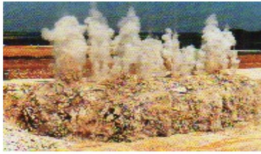
Figure 1 : Exemple d'extraction par abattage à l'explosif (Source : Cemex)
