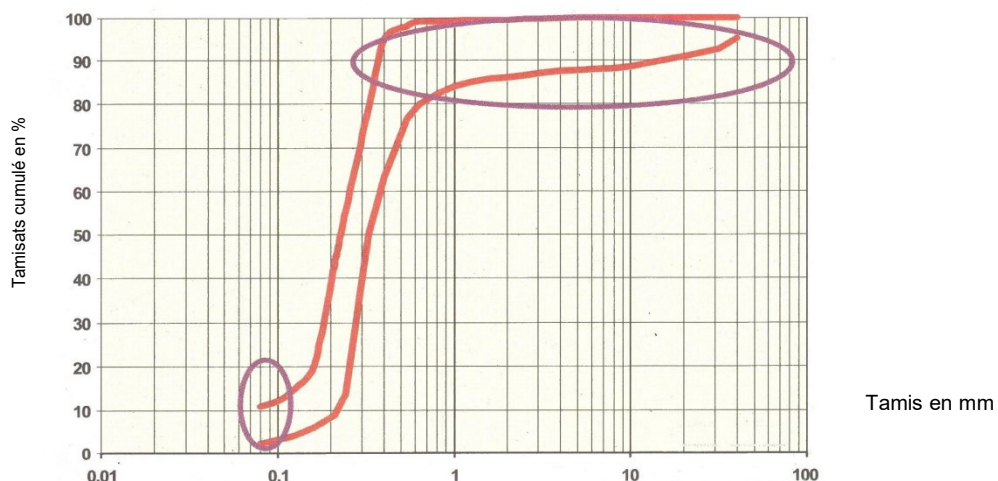
Figure n°3 : Exemple de distribution granulométrique de 2 sables usés [CETE Nord Picardie, 2002].
